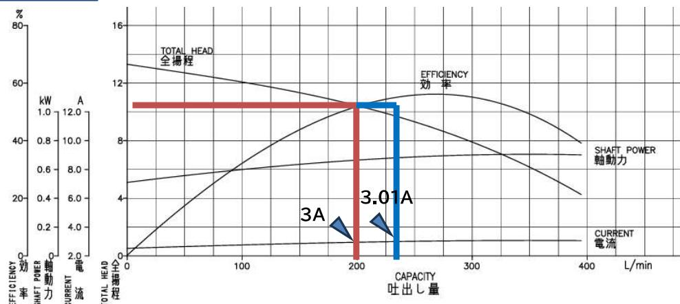
1.5kwポンプ付きのろ過機を追加した設備は、**38円/時の追加電力**が発生しておりました。\*1kwh=25円として算出
